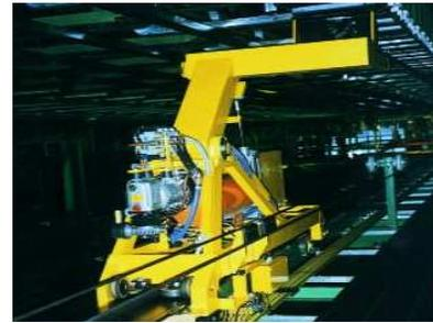
Fig. 4: Extrusion puller
